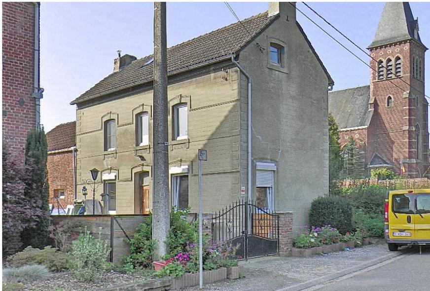
Dans la même rue, au numéro 26, les annexes « en long » ne manquent pas. Datant de 1898, cette construction a pu bénéficier de l'apport de pierres calcaires pour encadrer les portes, pour les appuis de fenêtres, pour les clés et les bords des linteaux de fe-
